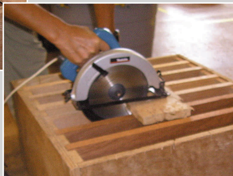
裝修用手提電鋸的護罩及輔助放置木料的活動底座
