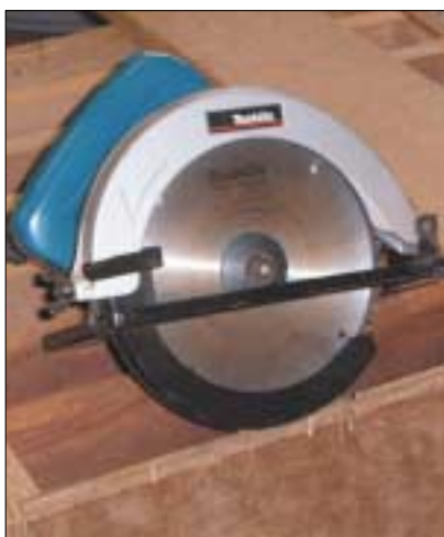
手提式風車鋸應在設計上裝有彈簧式的護罩，把大部分鋸齒遮攔。
