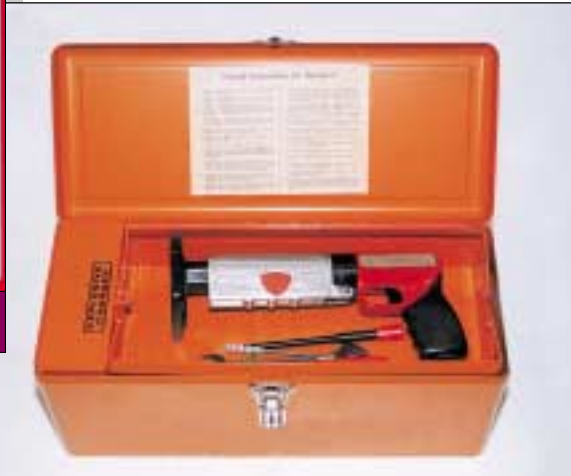
工具不用時，須拆除槍彈和釘，然後存放在適當的工具箱內，並加上鎖。
