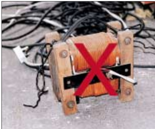
結構不良的電弧焊器具容易產生觸電危險。
