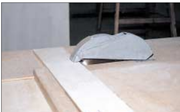
風車鋸應設有可調校的頂罩。
