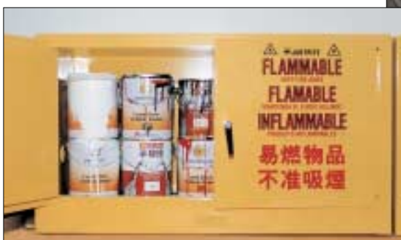
將易燃物品貯存於有掩門的金屬箱內，該掩門應能自動關閉。
